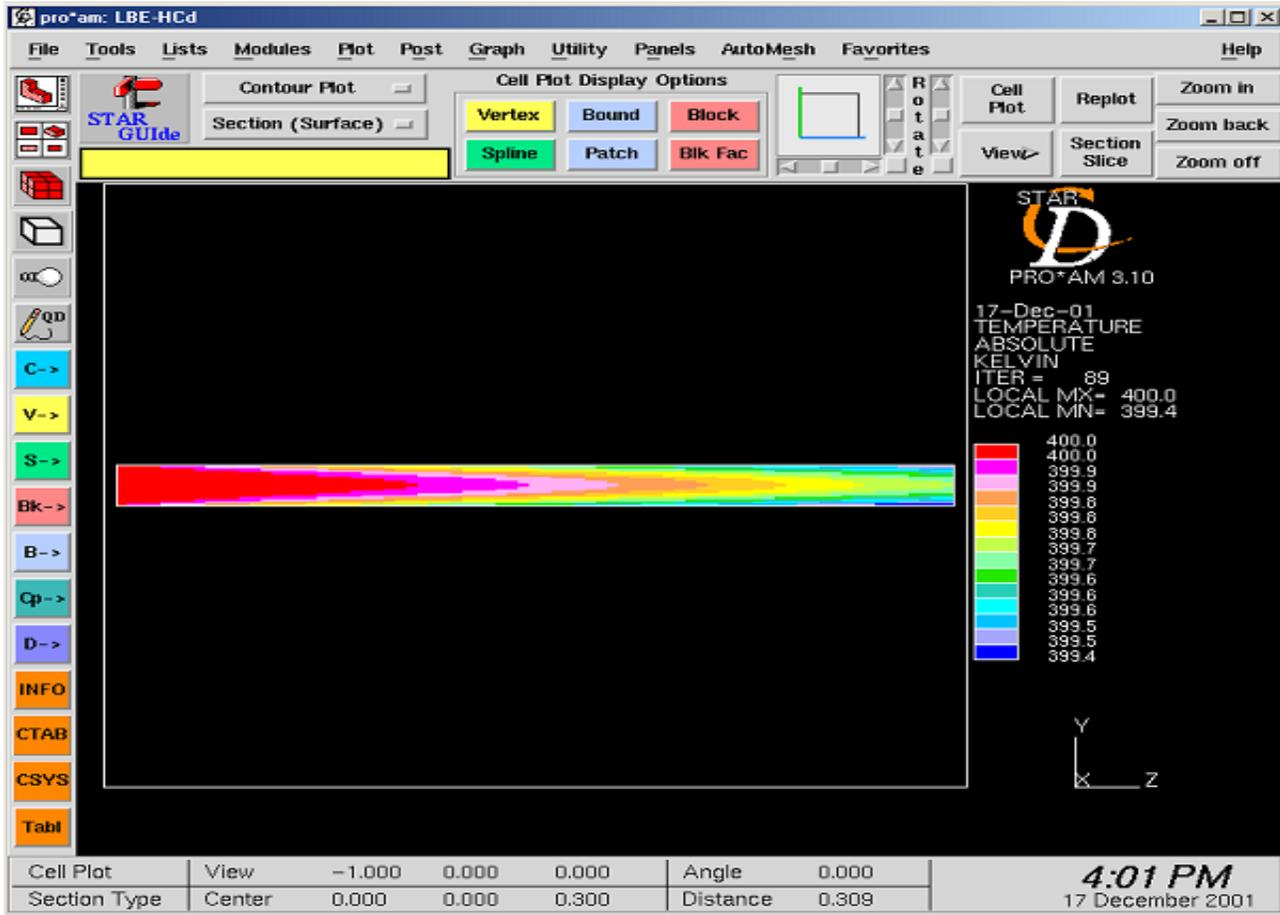
FIG-4: TEMPERATURE VARIATION ALONG THE AXIAL LENGTH OF THE PIPE
